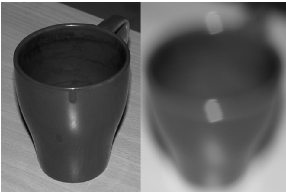
Obrázek 7.2. Fotografie získaná fotoaparátem s objektivem (levá strana) a bez objektivu pomocí dírkové komory (pravá strana)
