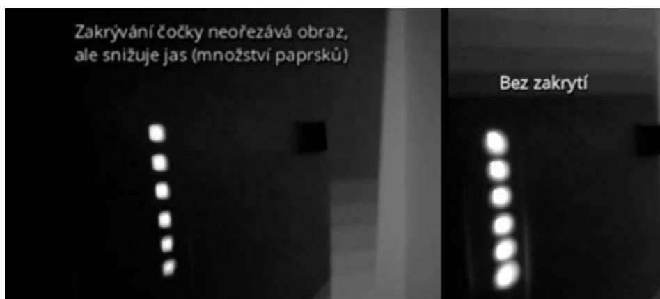
Obrázek 7.3. Obraz svítící USB lampy vytvořený nezakrytou čočkou (levá strana) a čočkou zakrytou z 80 % (pravá strana)
