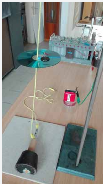
Obr. 25 Mapování magnetického pole kolem přímého vodiče
