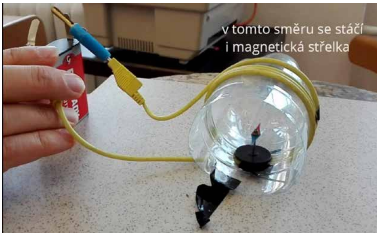
Obr. 17 Experiment mapující magnetické pole uvnitř cívky
