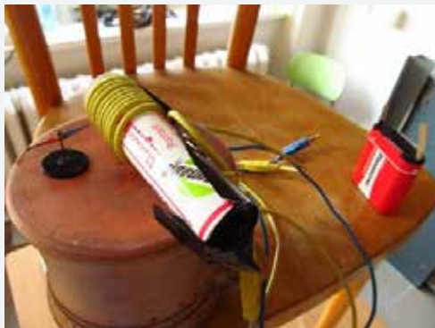
Obr. 24 Experiment mapování magnetického pole v okolí cívky
