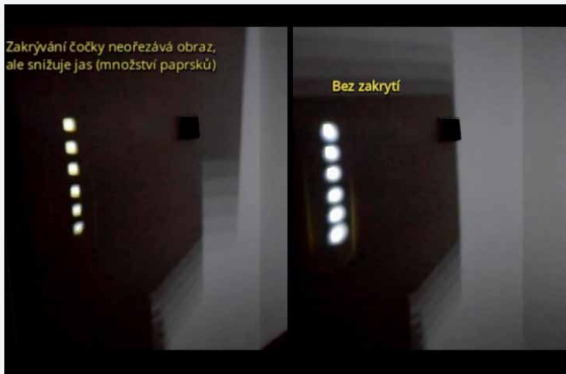
Obr. 70 Zobrazení bodových zdrojů světla spojnou čočkou s a bez částečného zakrytí čočky
