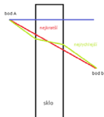
Obr. 59 Průchod světla sklem
