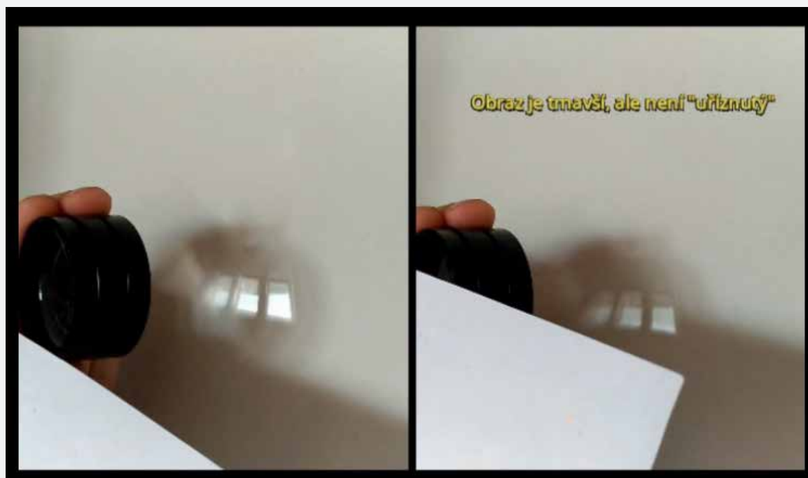
Obr. 69 Zobrazení předmětu spojnou čočkou a zobrazení předmětu spojnou čočkou z části zakrytou
