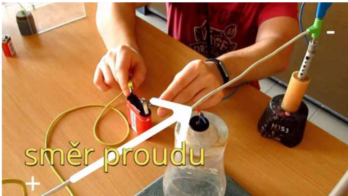
Obr. 13 Magnetka v blízkosti vodiče, který je připojen ke zdroji elektrického napětí
