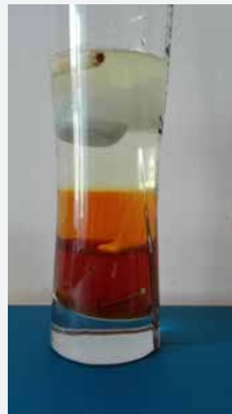
Obr. 52 Řešení experimentu „porovnání hustot“
