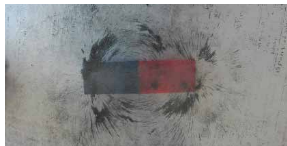
Obr. 35 Železné piliny zobrazující magnetické pole tyčového magnetu
