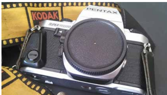
Obr. 55 Dírková komora z klasického fotoaparátu
