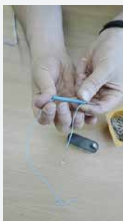
Obr. 22 Namotání drátku na hřebík
