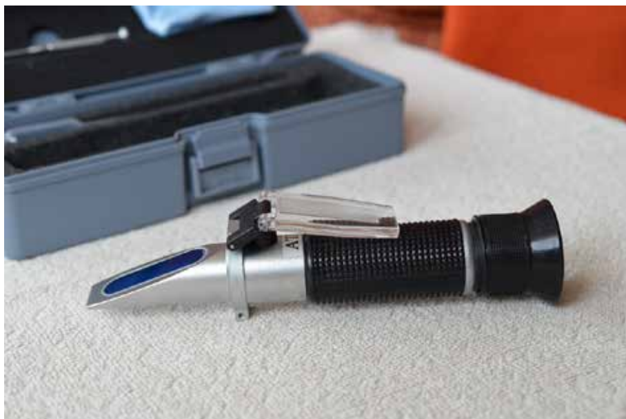
Obr. 7 Refraktometr pro ovocné šťávy a slané nálevy RBS2 – ATC
