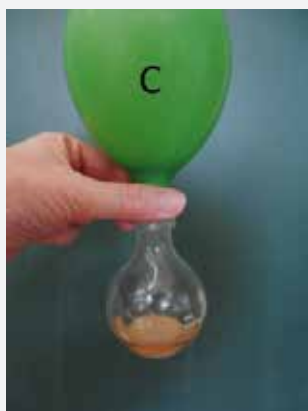
Obr. 2 Baňka C po reakci, na dně část nezreagované sody
