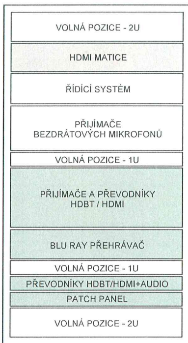
REŽIE EP130 SKLADBA POZIC VE STÁVAJÍCÍM RACKU 19"
