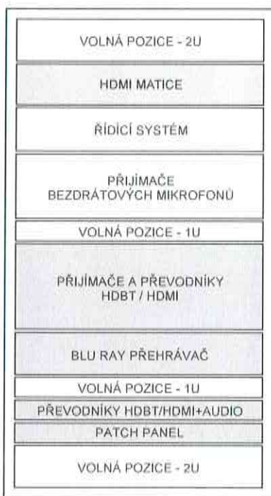
REŽIE EP130 SKLADBA POZIC VE STÁVAJÍCÍM RACKU 19"
